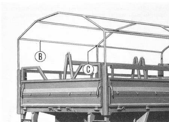
Fig. 53 - Asportato e ripiegato il telone, togliere i listelli B svitando le viti C.
