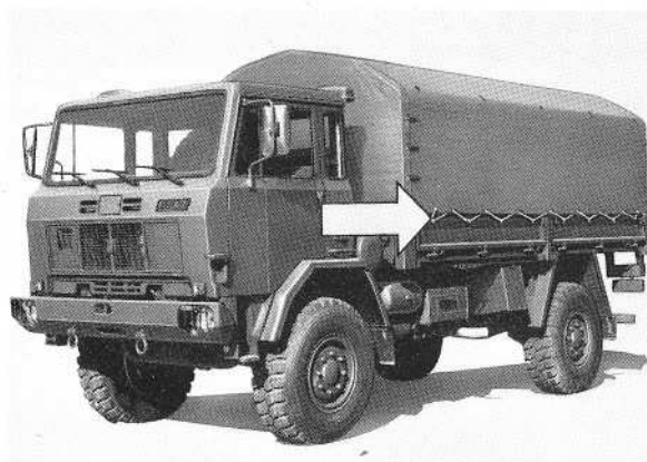
Fig. 51 - Prima di smontare il telone occorre sfilare la fune che lo vincola alle sponde.
